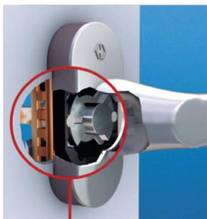
La poignée Secustik® intègre un mécanisme de verrouillage (breveté). Un élément situé entre la poignée et le carré permet une ouverture normale de la fenêtre PVC par l'intérieur mais bloque celle-ci si la poignée est manipulée depuis l'extérieur. Au moment de la rotation de la poignée, des goupilles de sécurité s'engagent dans des orifices spéciaux et produisent un son de cliquetis.
